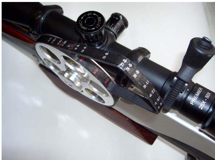
**колесо отстройки фокусировки прицела с нанесенным метражом**
