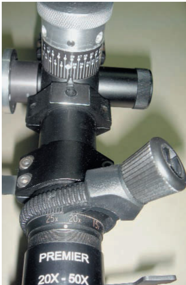
Увеличенный верхний барабан и ручка изменения кратности на прицеле Premier Reticle
