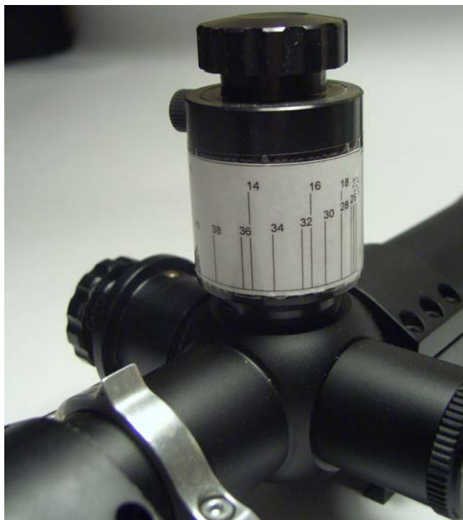
Барабан вертикальной поправки с разметкой в метрах, и указатель.
